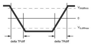
Differential Input Slew Rate definition for DQS, DQS and CK, CK
